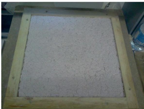
**Fig. 6** – *Fase di formatura del pannello con materiale fibroso*
