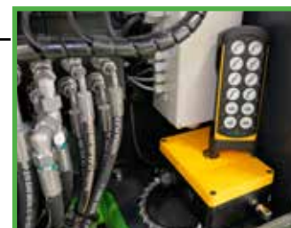
Radiocomando a distanza Varie funzioni idrauliche sono regolabili tramite radio comando
