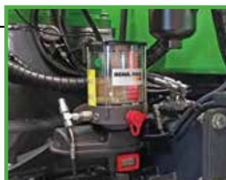
Lubrificazione centralizzata automatica Lubrificazione semplice e rapida
