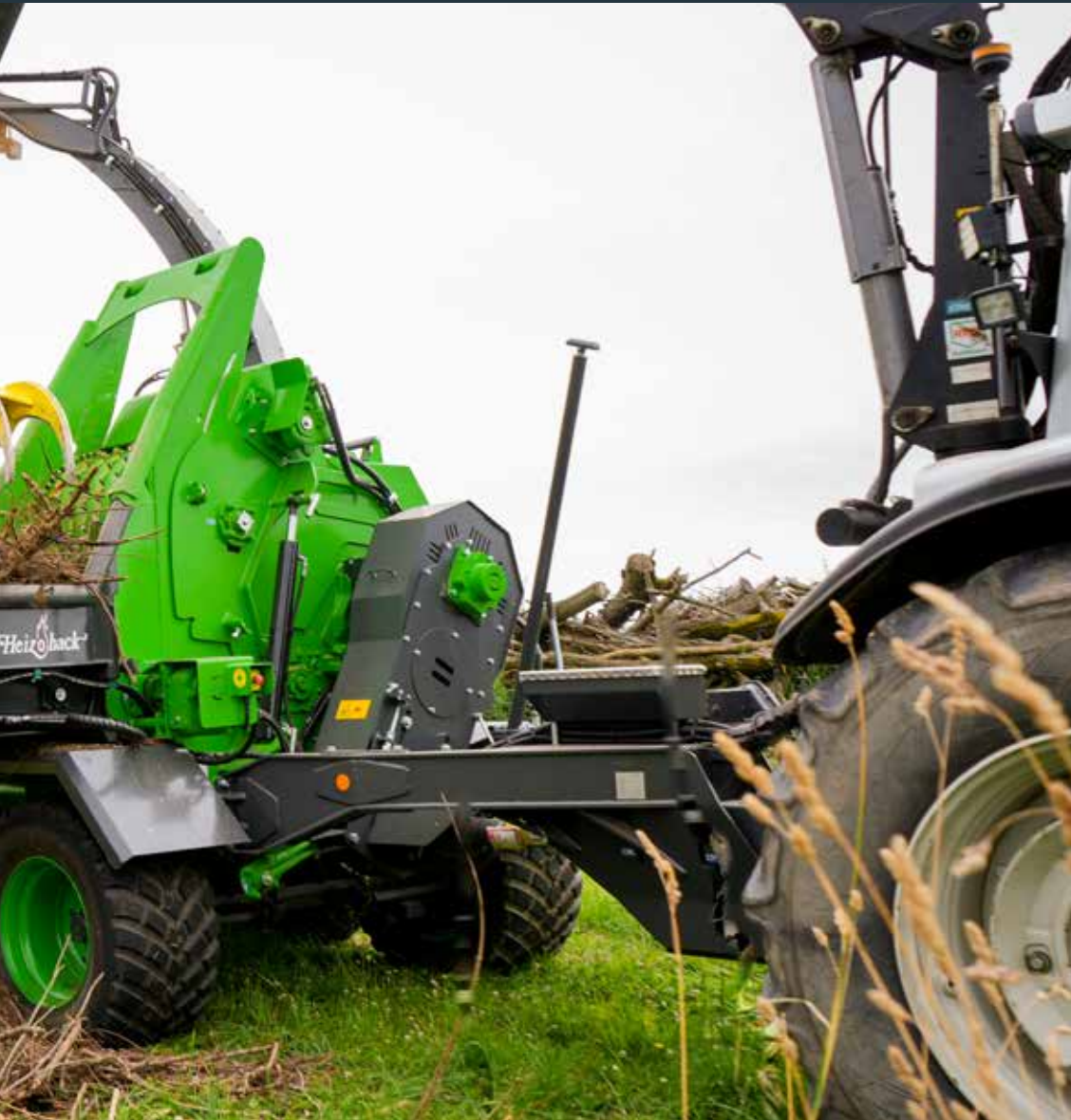
Rullo superiore aggressivo con D 800 mm e con altezza di carico fino a 800 mm
