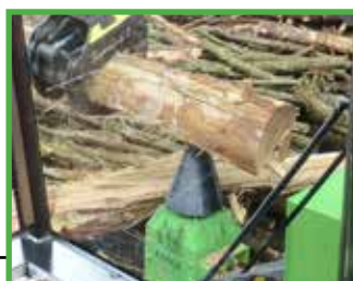
Spaccalegna a vite Per spaccare preliminarmente la legna, per quasi tutti i diametri di tronco
