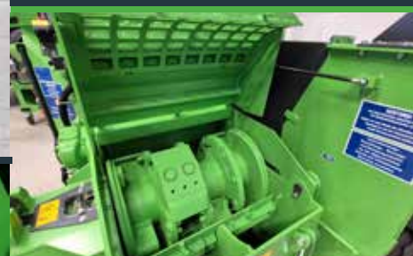
Superficie griglia maggiorata Rotore HM 8-400 GREEN Series
