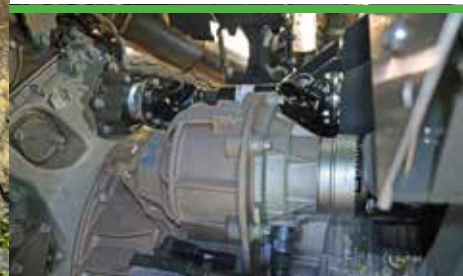
Trasmissione diretta dal motore alla cippatrice a piena potenza con garanzia di fabbrica.
