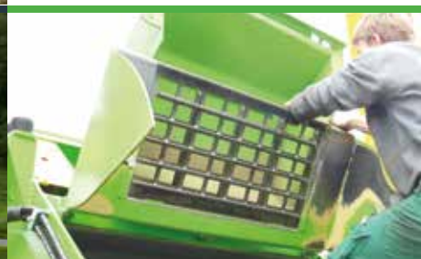
Coperchio del rotore con griglia supplementare
