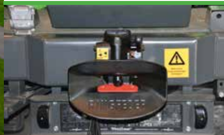
Gancio automatico con attacco aria compressa
