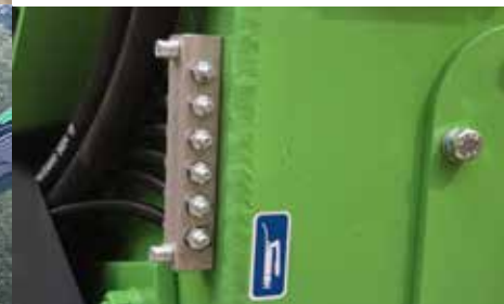
Linea di ingrassaggio centralizzato
