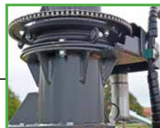
Rotazione elettrica del tubo di lancio Azionamento tramite motore elettrico
