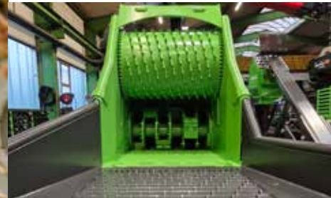
Rullo superiore aggressivo con D 800 mm e con altezza di carico fino a 800 mm
