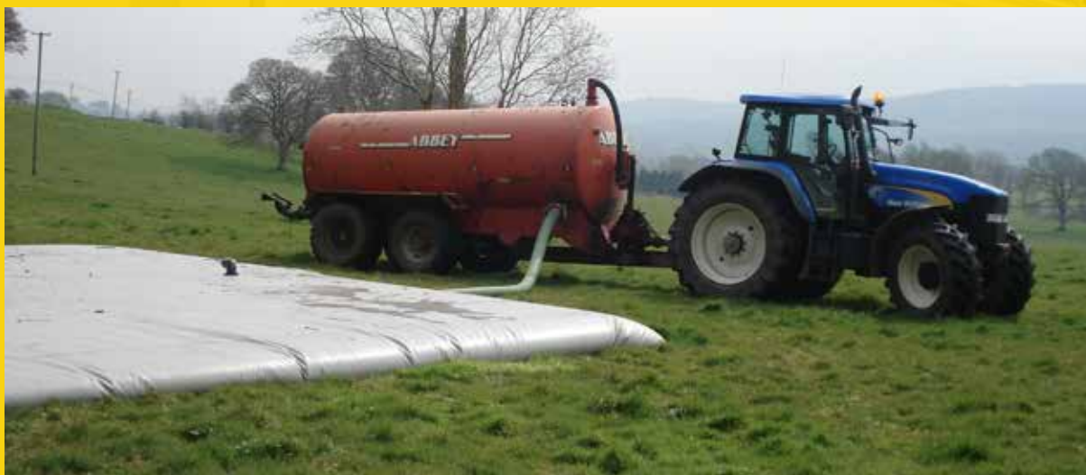
Serbatoio per lo stoccaggio di liquame
