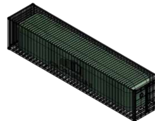
Sacco di gas in un container
